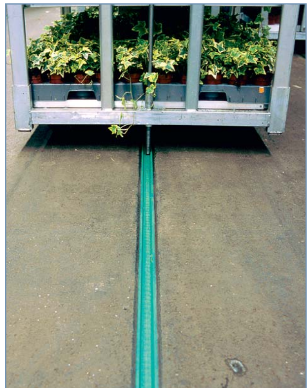
Afbeelding 1. Een sterk en slijtvast kettingglijprofiel van kunststof (Multilene MRG-groen) zorgt voor een soepel transport op een plantenveiling; bij een metalen rails zou dit alleen door (duurdere) rollen te realiseren zijn.
